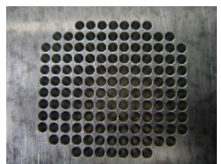
材質：A2017 処理無し 100×100t8.0 5440-φ0.7貫通穴
